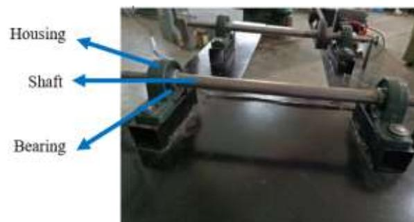
Fig. 39: Shaft assembly
